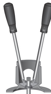
Figura 8: Remoción del sello mecánico
